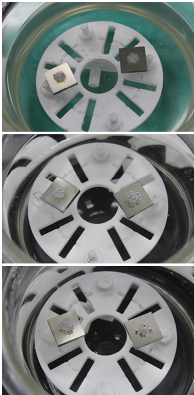
図 4.6 浸漬試験終了後の試験溶液内の外観 (浸漬試験条件 上:90°C、10,000ppm Cl - 、中:50°C、10,000ppm Cl - 、下:50°C、100ppm Cl - )
