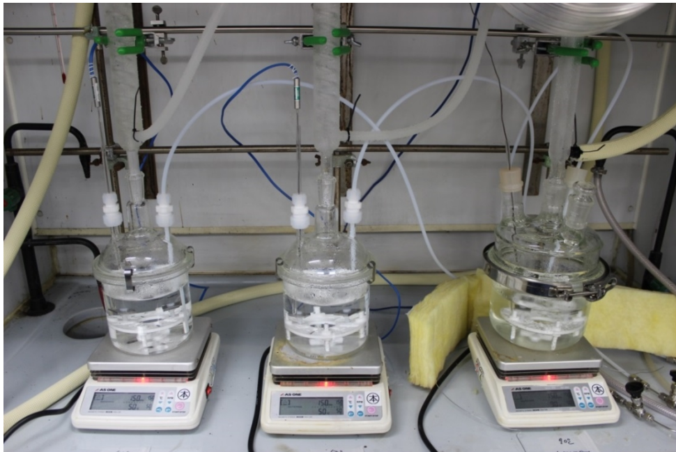
図 4.2 浸漬試験の外観(左:浸漬試験 No.5,6、中央:浸漬試験 No.3,4、右:浸漬試験 No.1,2)
