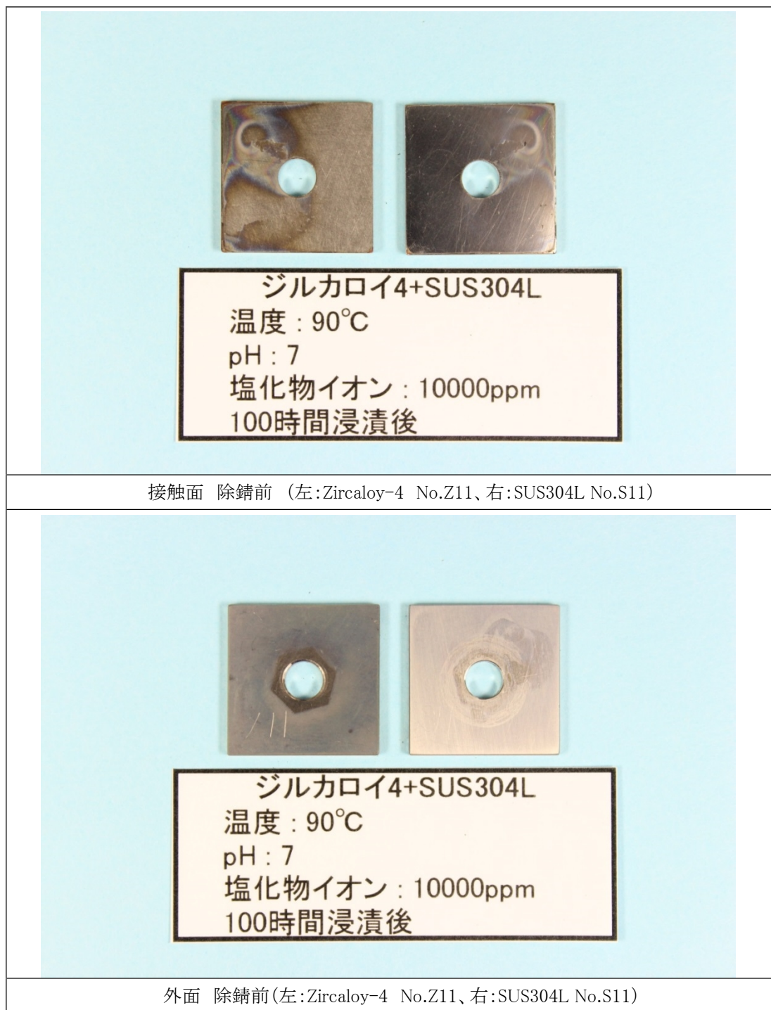
図 4.13 100 時間浸漬試験した後の試験片解体後の外観（浸漬試験 No.1）
