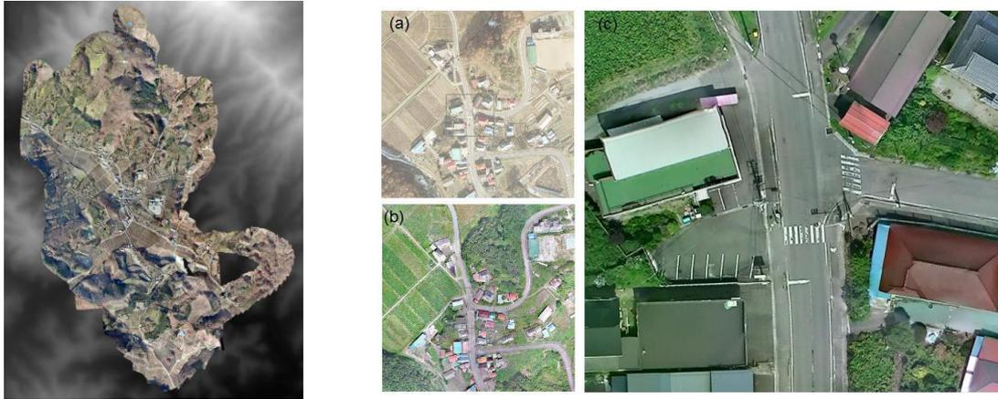
図 4.1 一回のヘリコプターのフライトによるビデオ画像から作成した山木屋地区中心部(中央が山木屋小学校)のオルソ空中写真(左)と山木屋比曾坂入口交差点付近の拡大画像
