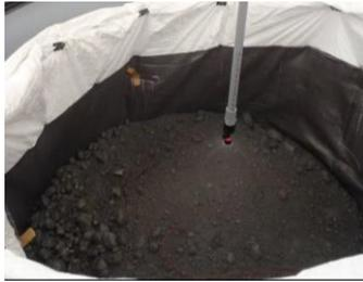
写真3-4 散水処理
