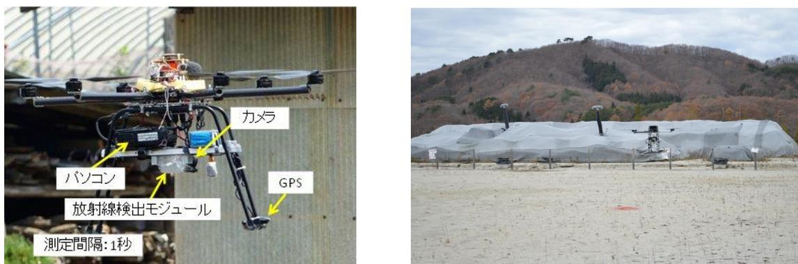
図 3.7 計測器を搭載して飛行中のミニサーベイヤー
