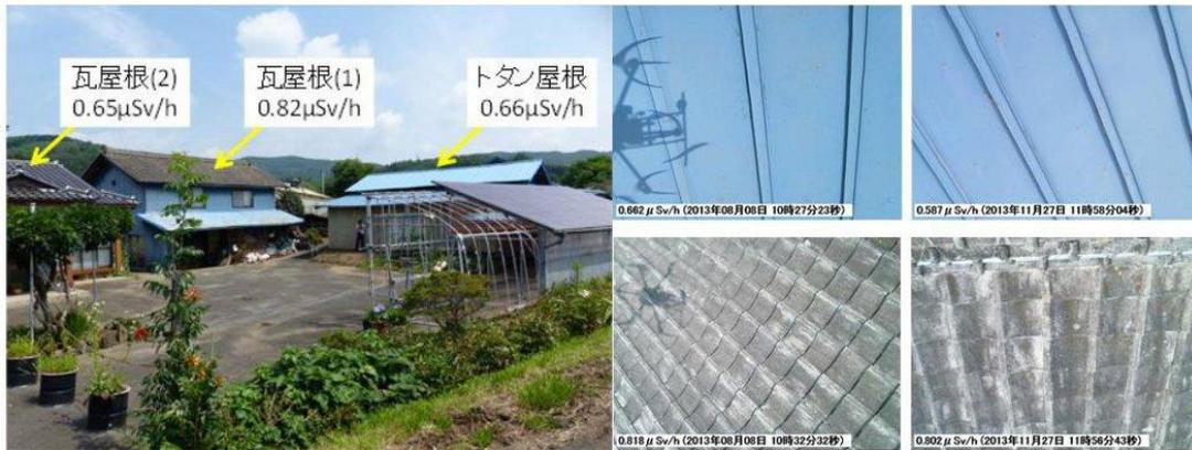
図 3.9 民家の屋根上の空間線量率計測および測定中の写真の撮影
