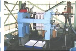
真空加圧脱水固化処理機(小型タイプ)
