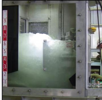
写真-2 単粒径の材料(ガラスビーズ)による対流状況確認
