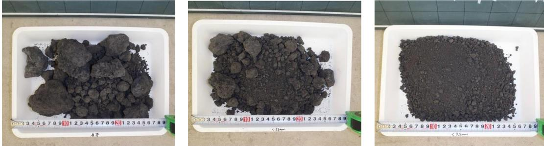
写真1-1 飛灰(有姿)      写真1-2 飛灰(53mm 以下)      写真1-3 飛灰(9.5mm 以下)
