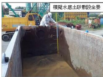
写真-4 模擬底泥敷設状況
