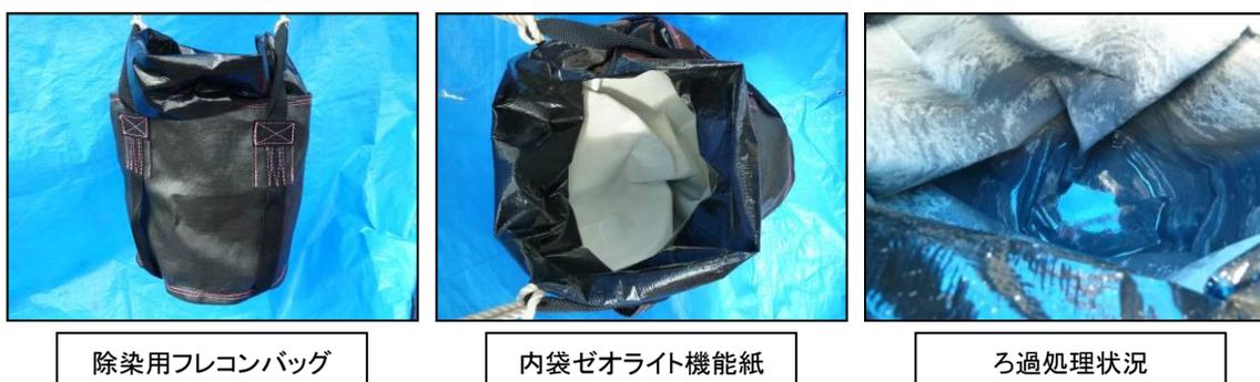
図1-6 除染用フレコンバッグ処理状況
