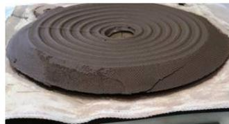
ろ液はCs 吸着システムに、土壌は処理土洗浄システムに供給される。
