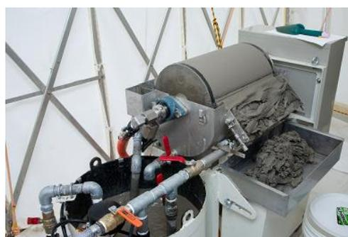
図 2.4 真空脱水機での飛灰回収状況
