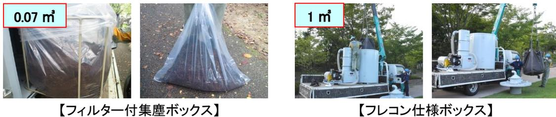
■考察:機器を使うことで手作業よりも少ない人員と短い時間で同じ面積の作業が可能で、更に、容量の大きいフレコン仕様ボックスに回収することで、作業時間の短縮が可能である。また、機器作業は破碎・減容も同時に行うため、回収物の減容作業が必要な場合は更なる時間短縮が可能である。
