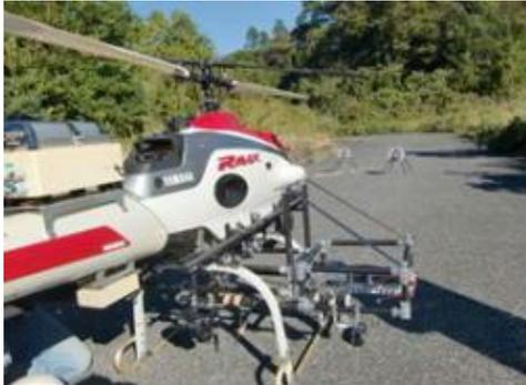
図 3.1 ウィンチを装着した RMAX
