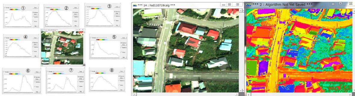
図 4.2 ハイパースペクトル計測による異なる地表面のスペクトル(左)、フォールスカラー画像(中)および分類結果(右)
