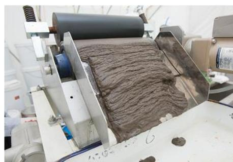
図 2.3 セパレータでの除染剤回収状況
