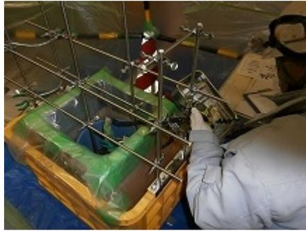
写真 2.18 放射線量の測定方法
