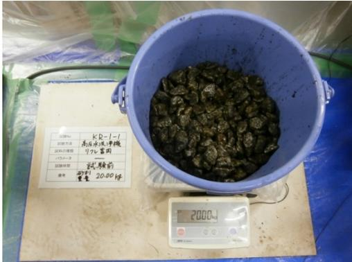
砂利重量測定 (試験前)
