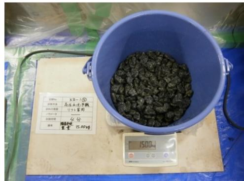
線量測定用重量 15kg 測定（試験後）
