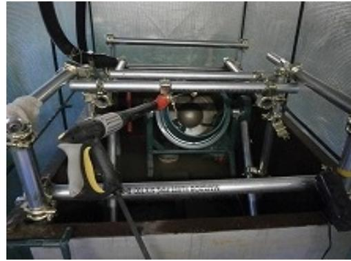
使用装置 (高圧水洗浄機)
