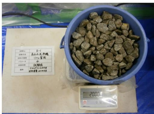
砂利重量測定 (試験前)
