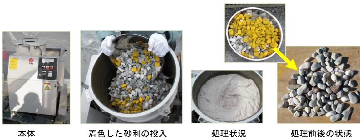
写真 2.1 バレル研磨機による模擬試験状況
