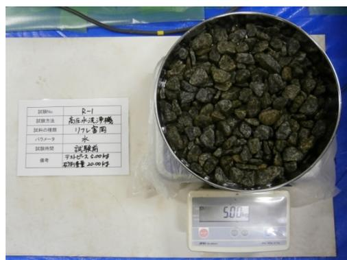
線量測定用重量 5kg 測定 (試験前)
