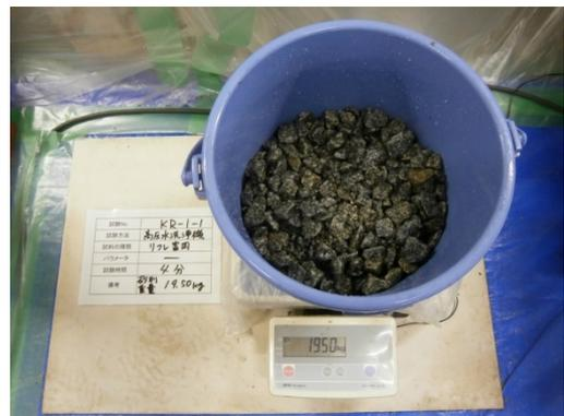
砂利重量測定（試験後）
