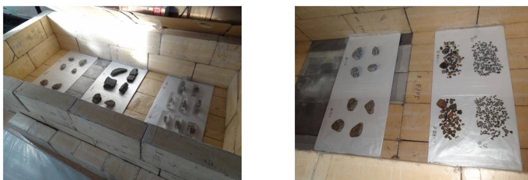
写真 3.3 IP シートと測定サンプルの設置状況
