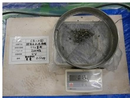
超高圧水洗浄機（4分試験後）
