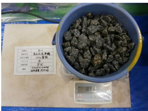
砂利重量測定（試験後）
