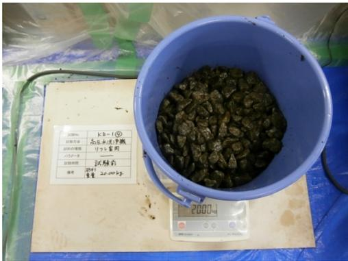
砂利重量測定 (試験前)
