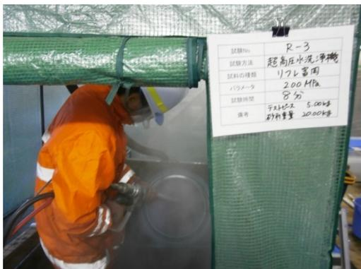
試験状況（超高压水洗浄機）
