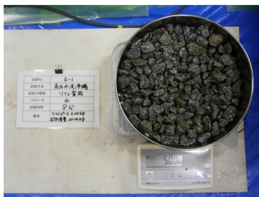
放射線量測定用重量 5kg 測定（試験後）
