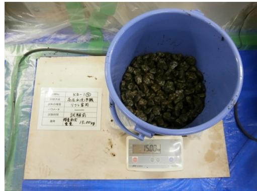
線量測定用重量 15kg 測定 (試験前)
