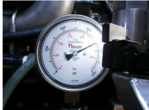
洗浄圧力調整 (250MPa)
