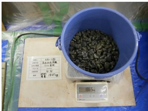
砂利重量測定（試験後）
