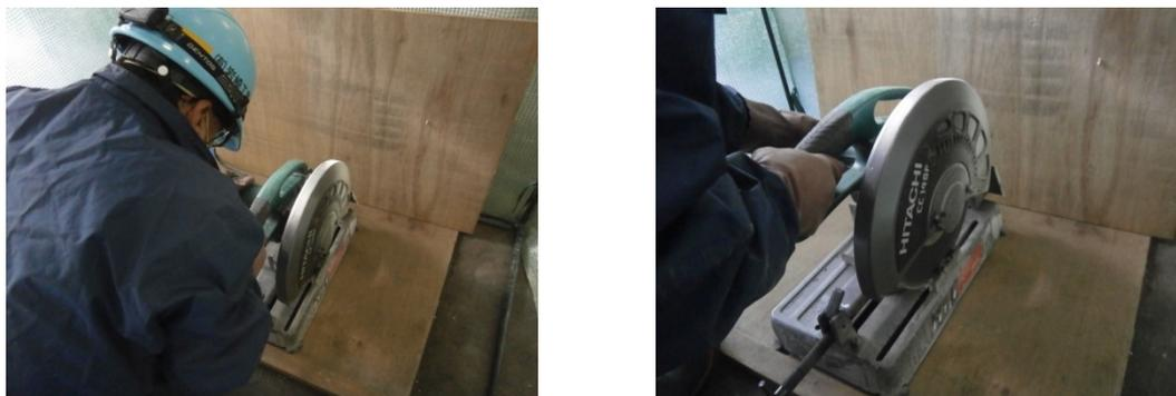
写真 3.2 IP サンプルのカット作業状況
