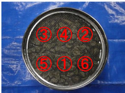
写真 2.14 テストピース板及び放射線量測定位置
